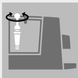
Filter in Wassertank eindrehen
