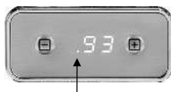
Temperatuur koffie boiler (t1, hier 93°C) -Komma in de 1e positie.
